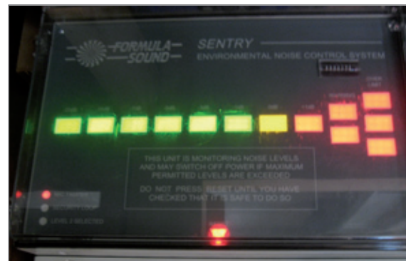
De groep kan op het toestel aflezen hoeveel decibels worden geproduceerd aan de buitendeur.
